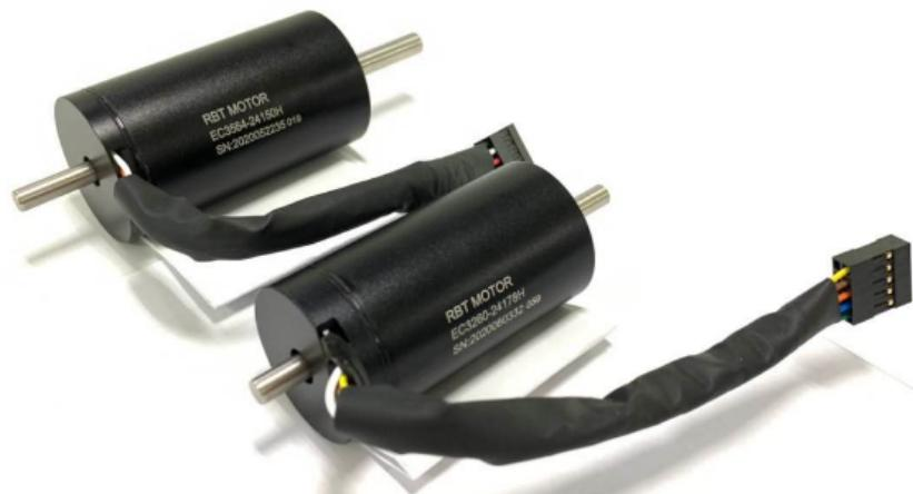
空心杯无刷电机的基本转动原理是什么？空心杯无刷电机的定子绕组多做成三相对称星形接法，同三相异步电动机十分相似。空心杯无刷电机的转子上粘有已充磁的永磁体，在空心杯无刷电机内装有位置传感器，可以检测电动机转子的极性。驱动器由功率电子器件和集成电路等构成，其功能是：接受空心杯无刷电机的启动、停止、制动信号，以控制电动机的启动、停止和制动；接受位置传感器信号和正反转信号，用来控制逆变桥各功率管的通断，产生连续转矩；接受速度指令和速度反馈信号，用来控制和调整转速；提供保护和显示等等。直流无刷同步电机生产公司空心杯无刷电机十多年来得到迅速的发展，尤其是在工业发达国家，已经涉及到大部分行业和许多产品。
